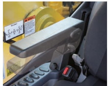
Armstütze mit einfacher Höhenverstellung
